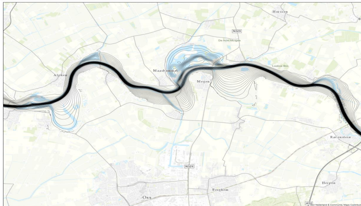
Figuur 6: Afvoerlijnen tijdens extreem hoogwater ( 4600 \text{ m}^3/\text{s} ), afvoer tussen 2 lijnen is 100 \text{ m}^3/\text{s}
